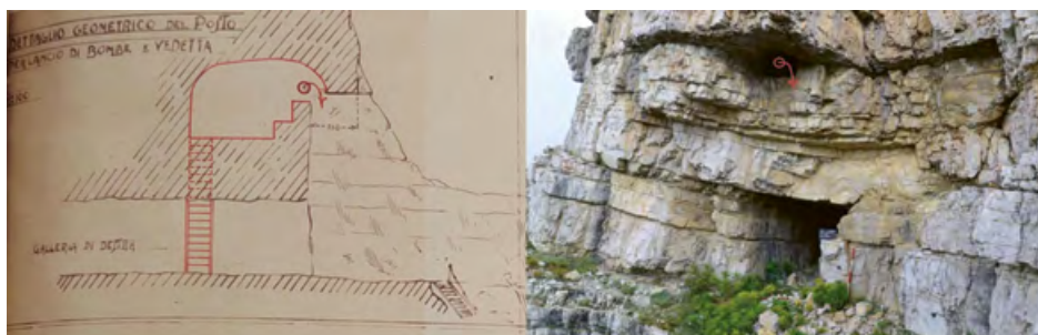
9 Sexten Alto, dettaglio geometrico del posto per lancio di bombe e vedetta, scala 1:400, estate 1917. Fonte: Archivio Ufficio Storico dello Stato Maggiore dell'Esercito, Roma, Carteggio 1917, I corpo d'armata, genio, sistemazione difensiva, B1 110D 29°. © AUSSME. Riproduzione autorizzata. Confronto con documentazione fotografica eseguita nel corso della campagna di rilievo del progetto "Written in the Landscape" nell'estate 2021. © 2021, unibz, WiL Archive. Riproduzione autorizzata.
